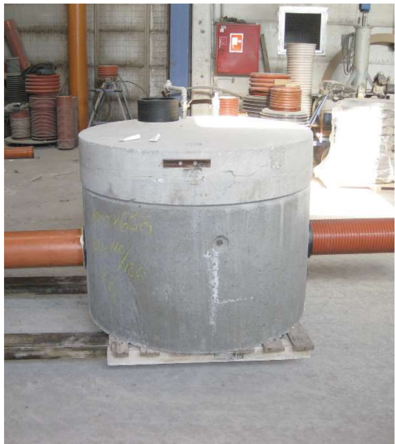
Brønd med påboringer, klar til afprøvning.
