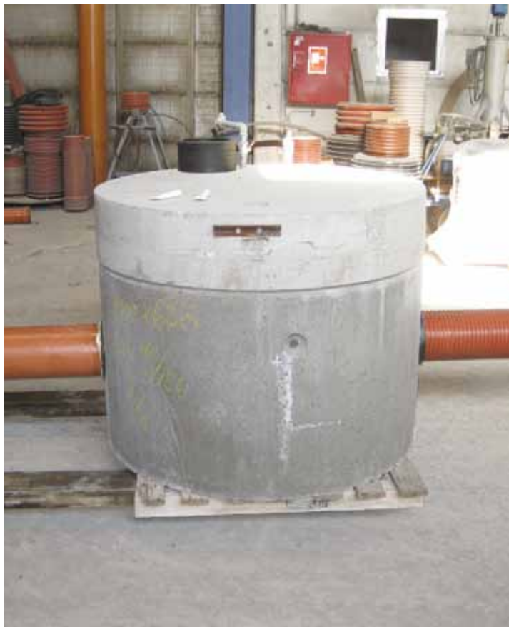
Brønd med påboringer, klar til afprøving.
